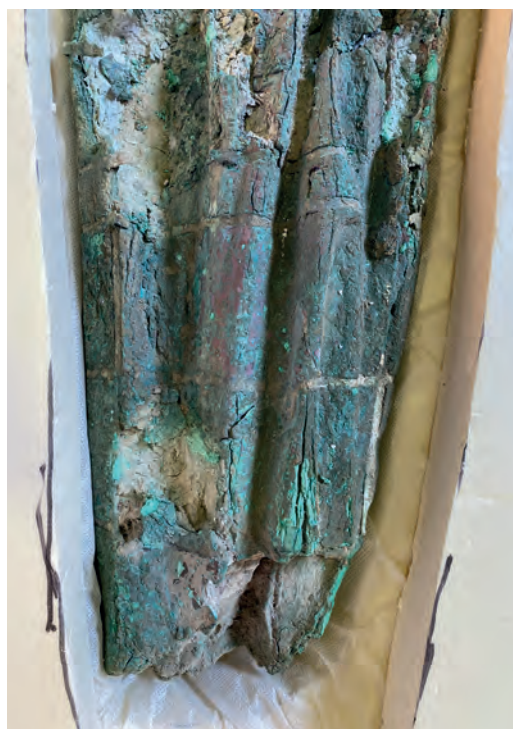
Fig. 27. Parte superior del paludamento con pérdidas de material provocadas por los cloruros de cobre activos. Foto: F. Marcos.
